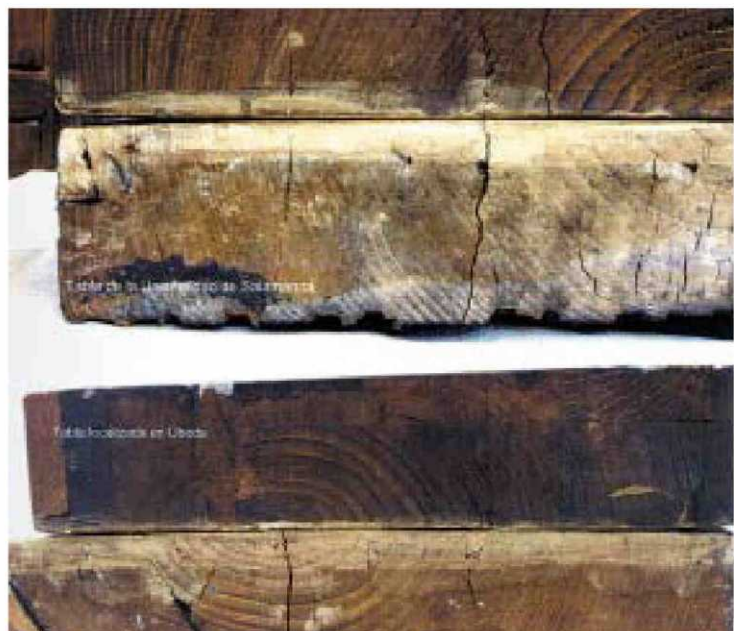
Coincidencia de los anillos de la madera de los laterales de la obra.
