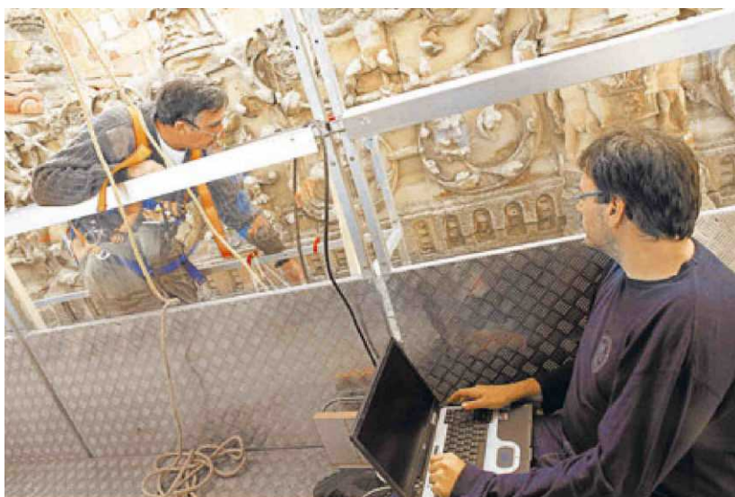
Los operarios realizan un barrido de la fachada con un georadar que transmite los datos al ordenador. /FOTOS: BARROSO
