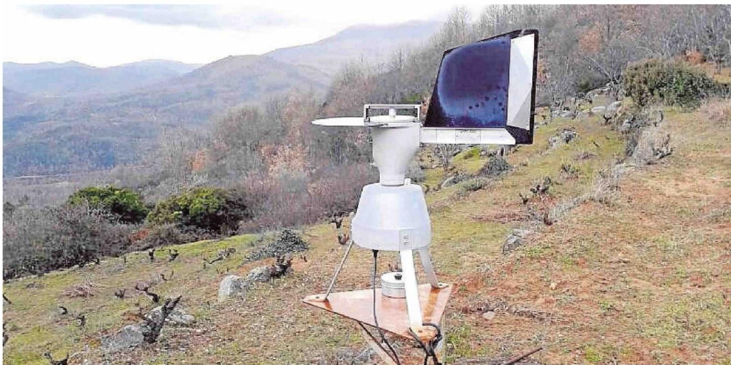
Captador de polen instalado en un viñedo de la localidad serrana de Villanueva del Conde.
