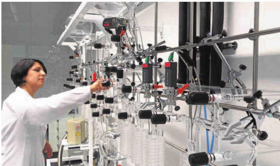
Imagen de la línea de alto vacío por extracción de benceno. :: FOTOGRAFÍAS CEDIDAS POR EL LABORATORIO
