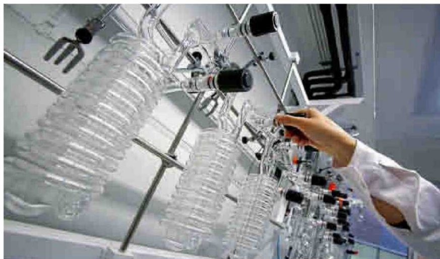
Imagen de la línea de alto vacío por extracción de benceno.
