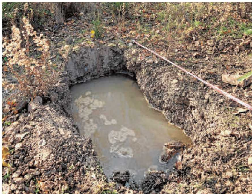
Aguas subterráneas halladas en el nuevo desarrollo urbano de El Marín a escasos metros bajo la superficie. | PMJU
